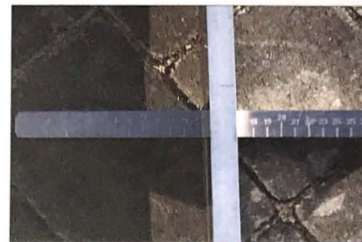
Berg und Tal: Die Messungen ergaben Abweichungen in der Höhe von bis zu 18 Millimetern.
